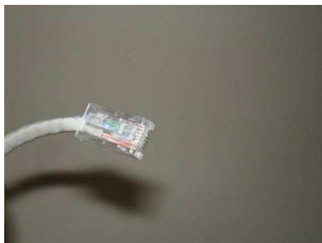
Hình 2: Cáp Ethernet với một đầu kết nối RJ-45
