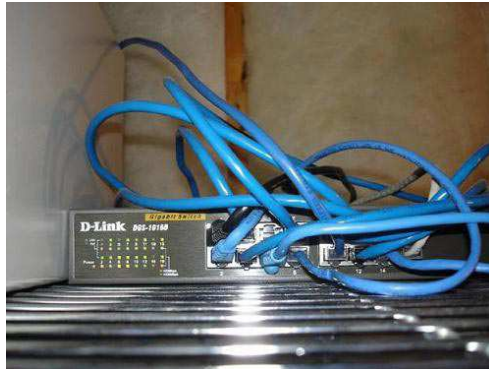
Hình 4: Switch trông giống hệt như hub nhưng hoạt động khác hơn nhiều.
